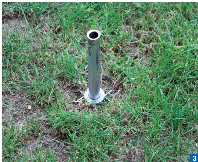
Déploiement des tiges à l'aide du mandrin et de la plaque fendue.
