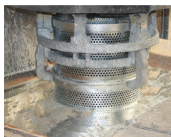
Pièces trempées dans le bain de zinc.
