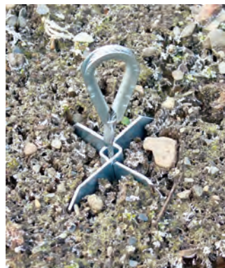
La cruz de refuerzo permite al anclaje no cortar el suelo.
