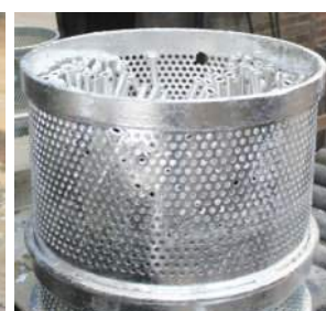
Cesto de peças galvanizadas.
